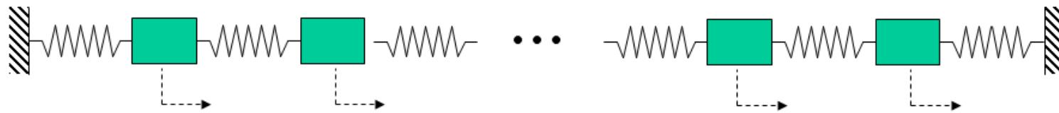
$$\begin{bmatrix} \dot{p} \\ \dot{v} \end{bmatrix} = \begin{bmatrix} 0 & I \\ T & 0 \end{bmatrix} \begin{bmatrix} p \\ v \end{bmatrix} + \begin{bmatrix} 0 \\ I \end{bmatrix} u$$
