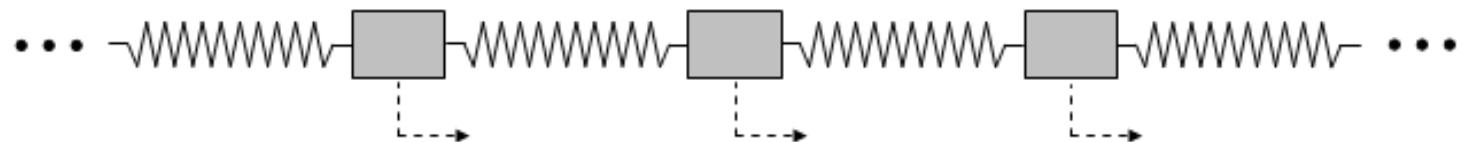
$$\dot{\psi}(x, t) = \begin{bmatrix} 0 & 1 \\ S_{-1} - 2 + S_1 & 0 \end{bmatrix} \psi(x, t) + \begin{bmatrix} 0 \\ 1 \end{bmatrix} u(x, t), \quad x \in \mathbb{Z}$$
