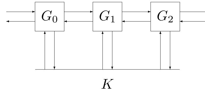
$$\begin{bmatrix} u_1(t) \\ u_2(t) \\ u_3(t) \\ u_4(t) \end{bmatrix} = - \underbrace{\begin{bmatrix} * & * & * & * \\ * & * & * & * \\ * & * & * & * \\ * & * & * & * \end{bmatrix}}_{K_p} \begin{bmatrix} p_1(t) \\ p_2(t) \\ p_3(t) \\ p_4(t) \end{bmatrix} - \underbrace{\begin{bmatrix} * & * & * & * \\ * & * & * & * \\ * & * & * & * \\ * & * & * & * \end{bmatrix}}_{K_v} \begin{bmatrix} v_1(t) \\ v_2(t) \\ v_3(t) \\ v_4(t) \end{bmatrix}$$
