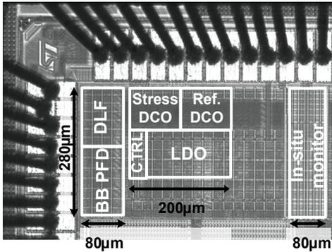
Fig. 12. 65nm all-digital PLL test chip die photo
